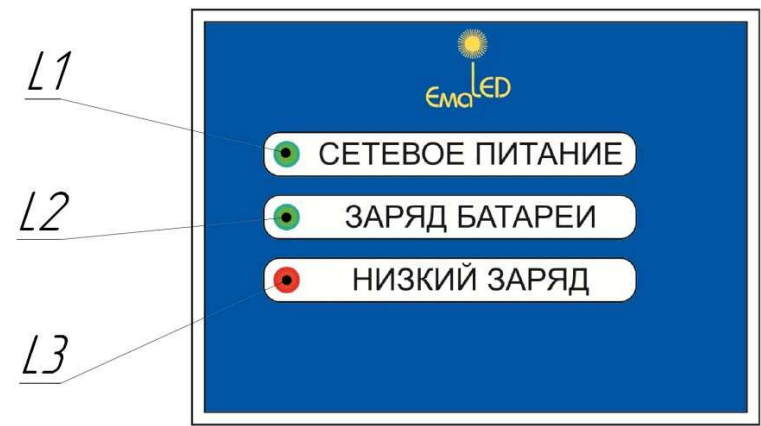
L1, L2, L3 – Светодиоды индикации режимов блока аварийного питания
